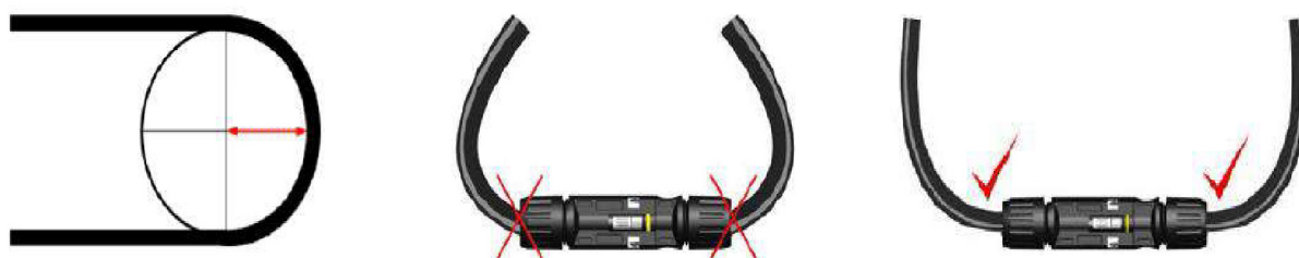
FIGURE 21 RAYON DE COURBURE MINIMAL DU CÂBLE
