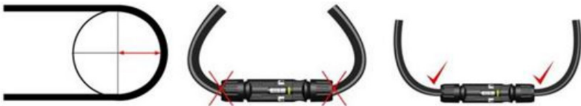
FIGURE 45 RAYON DE COURBURE MINIMAL DU CÂBLE
