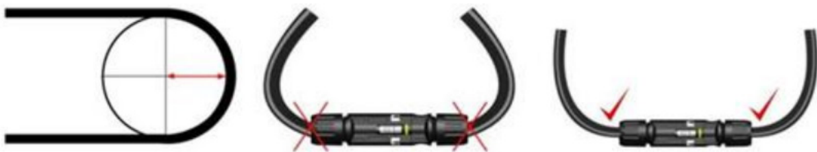
FIGURE 29 RAYON DE COURBURE MINIMAL DU CÂBLE
