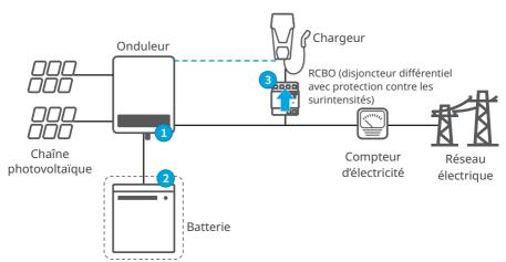
Étape 1 Allumez les interrupteurs CA et CC côté onduleur.
